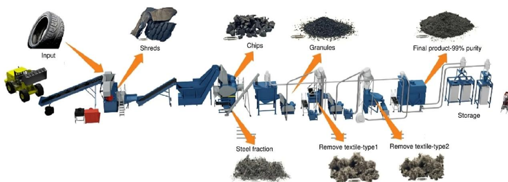
รูปที่ 10 กระบวนการการบดย่อยยางล้อ
